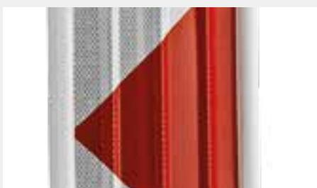
Das patentierte, wellenförmige Oberflächenprofil reflektiert das Scheinwerferlicht auch bei spitzen Strahlungswinkeln sehr viel deutlicher. Auch schräg und längs einfallendes Licht wird so gebrochen und der Rückstrahlwinkel ist deutlich größer. Das bringt Sicherheit durch erhöhte Sichtbarkeit!
