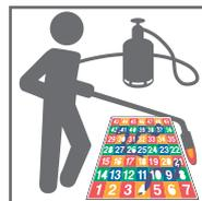
Die Applikation erfolgt schnell und einfach: Es wird lediglich eine Person, ein Besen und ein Gasbrenner benötigt! Lediglich die Oberfläche sauber fegen, Material verlegen und mit einem Gasbrenner applizieren, ggf. ist noch ein Primer erforderlich. So einfach ist das!
